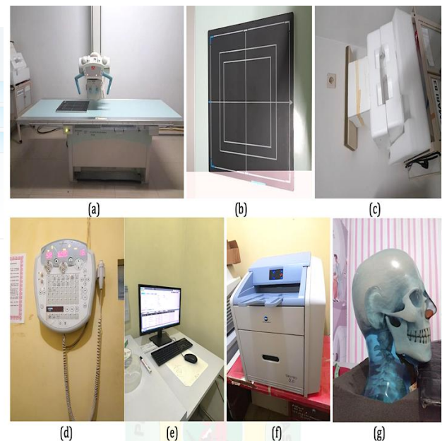
Gambar 1 | Alat dan Bahan (a) Pesawat X-ray Konvensional, (b) Flat panel detector, (c) Alat fiksasi, (d) Control panel Faktor Eksposi, (e) Computer Radiografi, (f) Printer Processing, (g) Phantom
